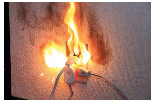
トラッキング火災（再現実験）
